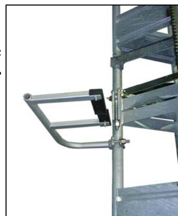
Рис. 23 Кабелепровод для волочащегося кабеля
